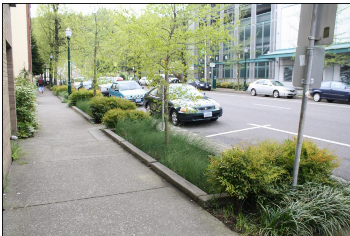
Abbildung 11: Beispiel eines Tiefbeetes (Portland, USA) [Quelle: IPS 2016]
